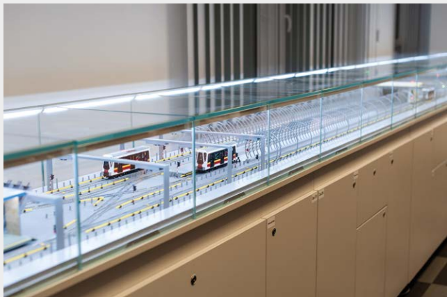
Układ torowy na makiecie identyczny z nowobudowanym odcinkiem II linii metra w kierunku wschodnim od stacji C15 „Dworzec Wileński” do stacji C18 „Trocka”
