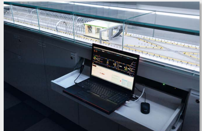
Stanowisko operatorskie zgodne w warstwie interfejsu użytkownika z eksploatowanym w Metrze Warszawskim systemem WT ZSiKD produkcji Rail-Mil Computers
